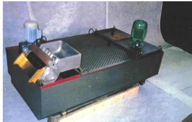
Magnetabscheider werden auch häufig als Hauptfilter in einer entsprechenden Filteranlage eingesetzt. Unser Foto zeigt eine FA - MA100 mit Behälter und Pumpe.
