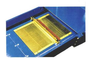
oder Sie entscheiden sich für den Einsatz unseres Integralförderers, der mit eingebauten Spaltrohren in den Feinheiten  $30\mu$ ,  $50\mu$  oder einer anderen Feinheit das Kühlmittel reinigt.
