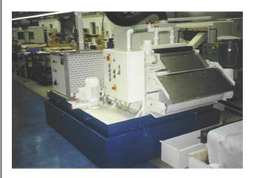
Schrägbettfilter stellen eine platzsparende Alternative zum Papierbandfilter dar. Auf einer geringen Grundfläche können Filterleistungen bis zu 600 l/min. erreicht werden. eine Leistung, die mit Papierbandfiltern nicht zu erreichen ist. Die kompakt gebauten Behälter, die das gereinigte Kühlmittel aufnehmen werden, wenn vom Kunden aewünscht. mit einer zweiten Sicherheitswanne versehen um allen Anforderungen Umweltschutzes des (Wasserhaushaltsgesetz) zu genügen.
