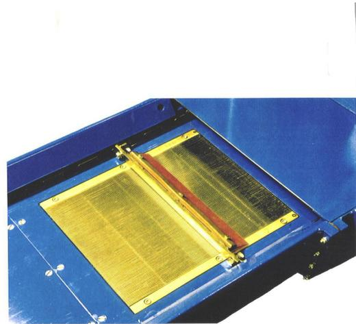
Oder Sie entscheiden sich für den Einsatz unseres Integralförderers, der mit eingebauten Spaltrohren in den Feinheiten 30 $\mu$ , 50 $\mu$  oder einer anderen Feinheit das Kühlmittel reinigt.
